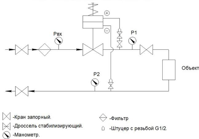
Схема подключения регулятора перепада давления при установке на обратном трубопроводе.
