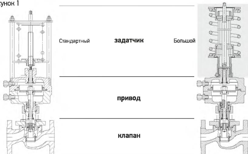
**3.3. ВНИМАНИЕ!** Во избежание повреждения мембраны не допускается подавать давление на штуцер «-» поз. 13 или устанавливать заглушку. Штуцер «-» всегда должен быть открыт на атмосферу. Рабочее давление (давление, подаваемое в рабочую полость мембранной коробки штуцер «+») не должно превышать 1,1 МПа.
